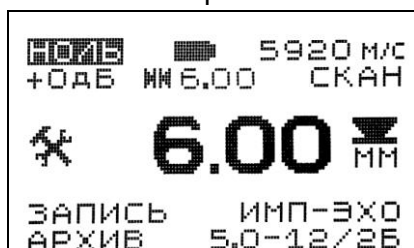
Вид экрана в режиме измерений толщины
