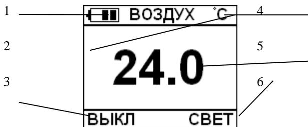
*1 – заряд аккумулятора; 2 – режим измерения; 3 – подпись левой функциональной клавиши; 4 – параметр измерения; 5 – измеренное значение; 6 – подпись правой функциональной клавиши.*
