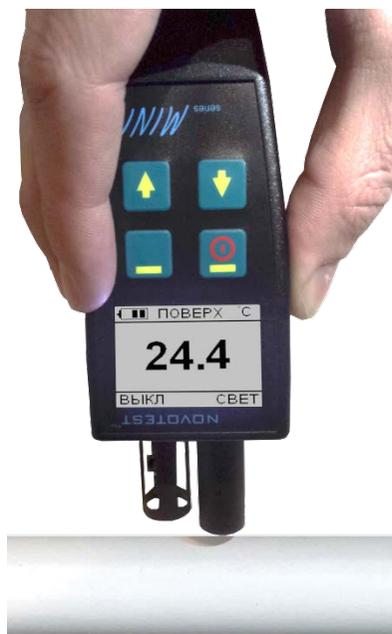
Рисунок 2.4 – Изображение прибора при измерении температуры поверхности
