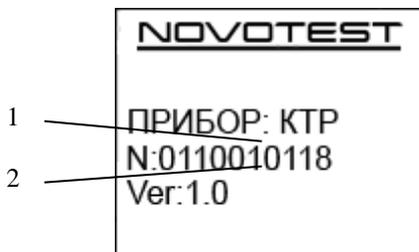
*1 – серийный номер прибора; 2 – версия программного обеспечения.*
