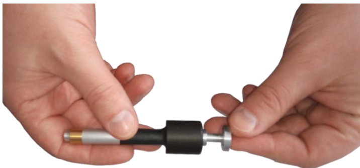
Рисунок 2.40 – Взвод пружины преобразователя
