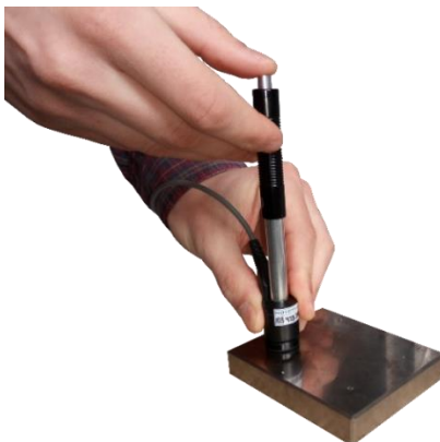
Рисунок 2.44 – Нажатие спусковой кнопки преобразователя
