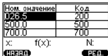
Рисунок 2.20 – Установка значений твердости образцов
