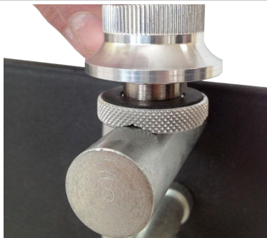
Рисунок 1.5 – Измерение твердости на цилиндрических поверхностях
