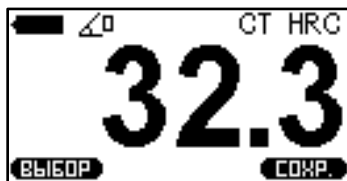
Рисунок 2.45 – Графический индикатор после проведения замера
