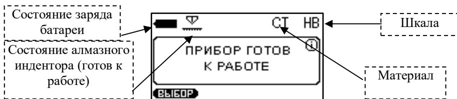
Рисунок 2.6 – Графический индикатор в измерительном режиме
