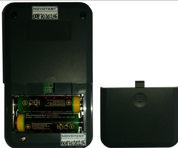
Рисунок 2.1 – Установка элементов питания
