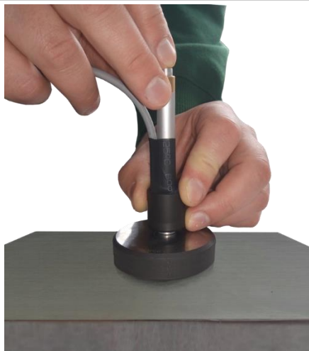
Рисунок 2.41 – Проведение измерения на притертом образце
