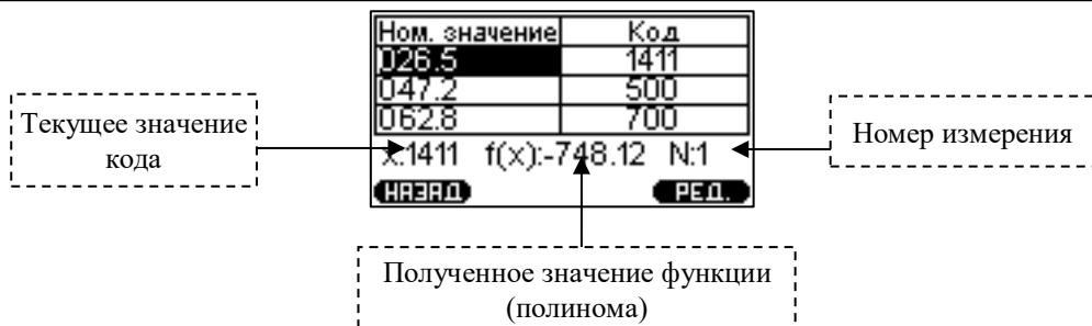
Рисунок 2.21 – Калибровка первого образца
