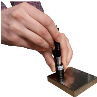
Рисунок 2.43 – Взвод пружины преобразователя
