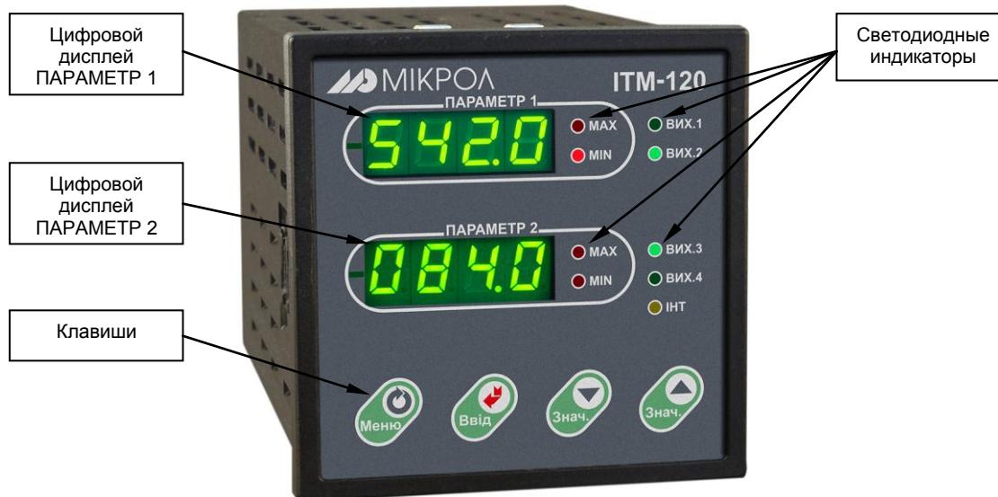
Рисунок 3.1 - Внешний вид передней панели индикатора ИТМ-120У
