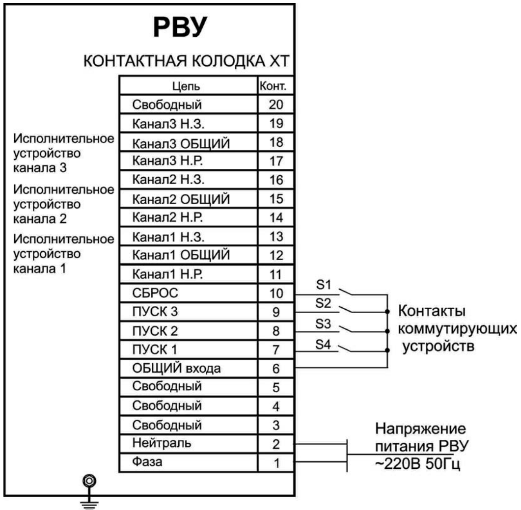
Схема внешних подключений реле РВУ
