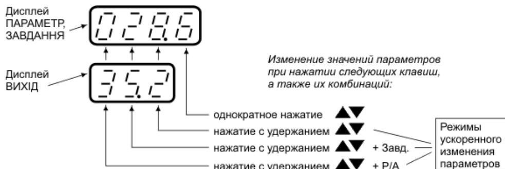
Рисунок 4.3 - Изменение значений на различных дисплеях
