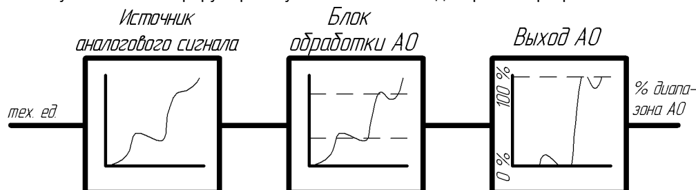
Рисунок 3.6 – Работа блока аналогового вывода в режиме ретрансмиссии
