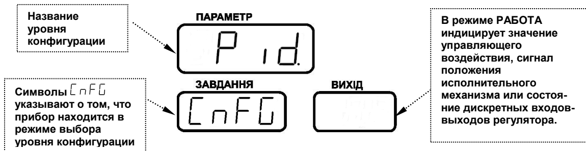
Рисунок 4.3 - Индикация значения параметров конфигурации и их номеров.
