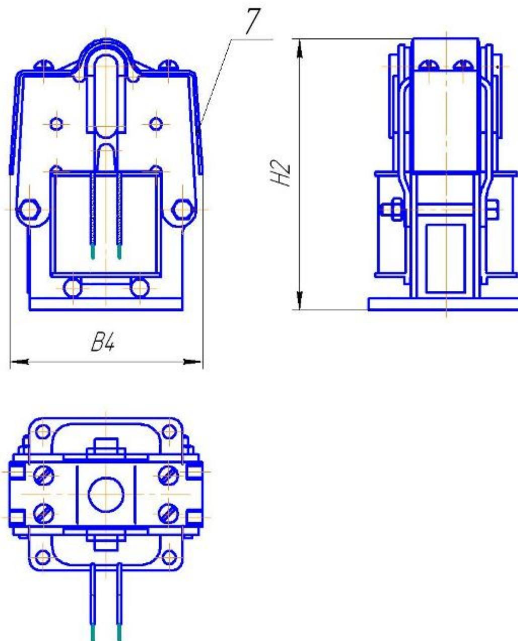
Рис.3 Электромагнит тянущий и толкающий
