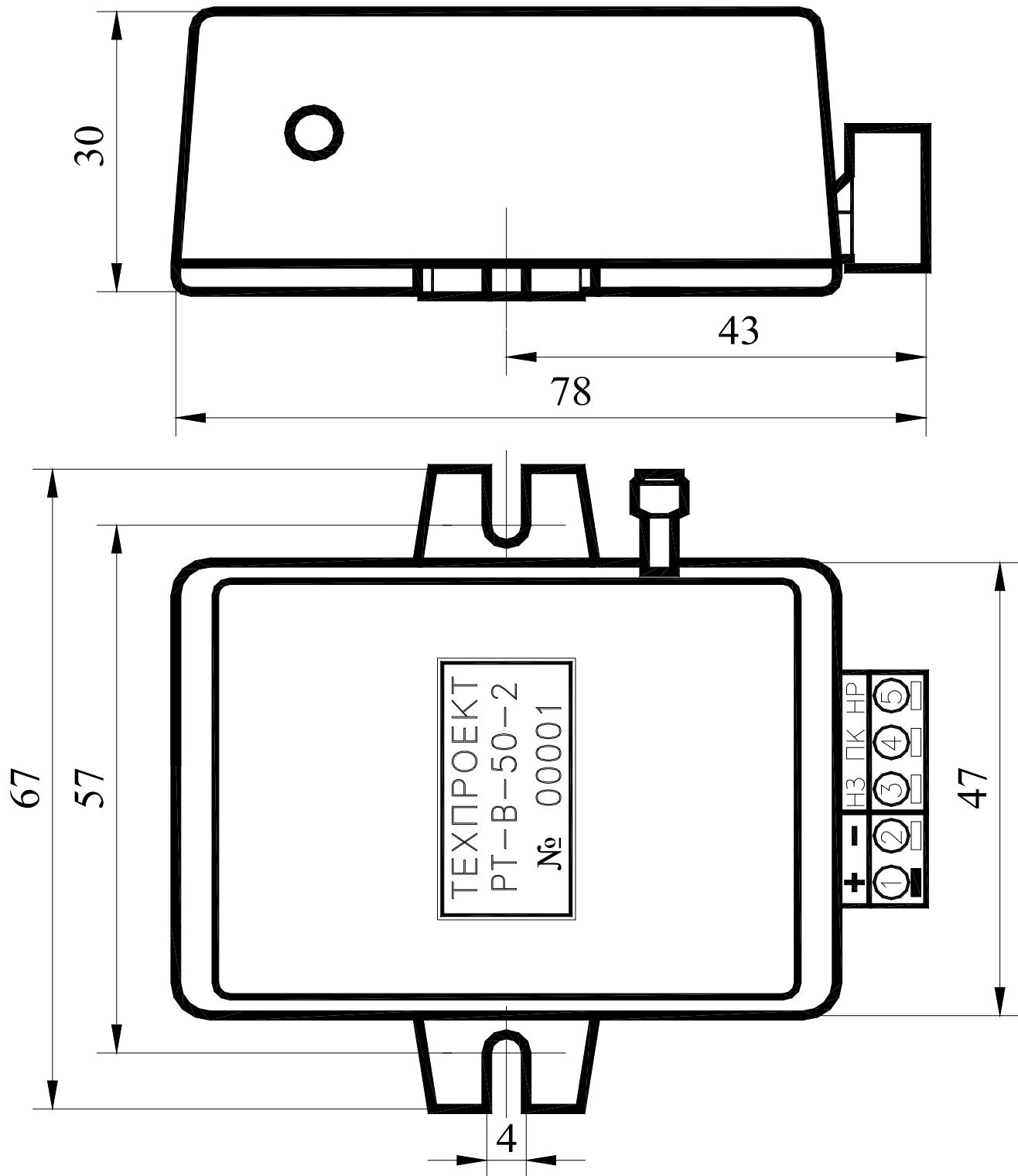
Рисунок 1 - Габаритные размеры РТ-В ААРЛ.433647.004-01
