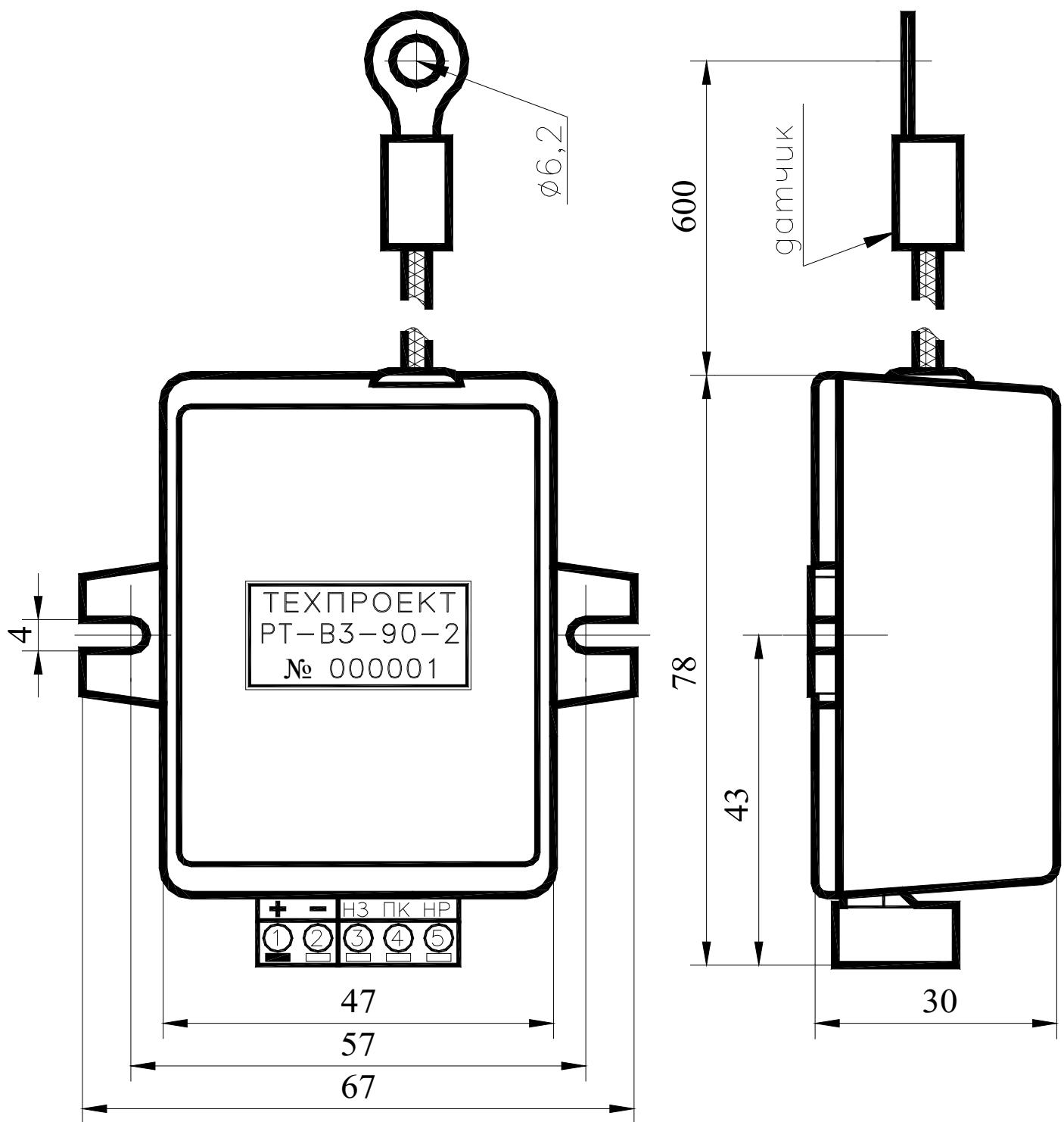
Рисунок 1 - Габаритные размеры РТ-В3 ААРЛ.433647.004-05
